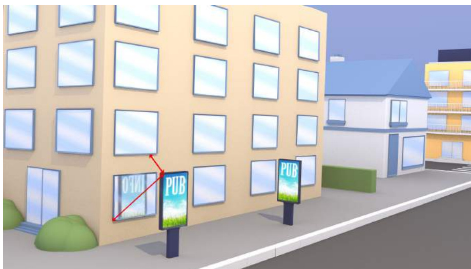
L'implantation du mobilier urbain* de gauche supportant de la publicité numérique est irrégulière car il est situé à moins de 10 m de la baie* d'un fonds voisin, visible de la baie* et parallèle à celle-ci.
