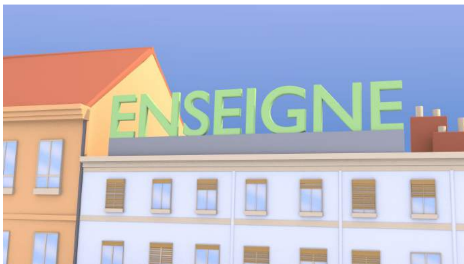
Une enseigne en toiture (comme une publicité) doit être composée de lettres découpées sans fixations visibles. Bandeau technique de 0,50 m maximum.
